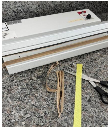
Figura 130 Troca da fita da seladora do setor.
