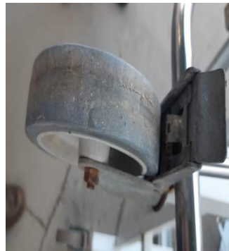
Figura 70 Corretiva e lubrificação na roda da maca do setor.
