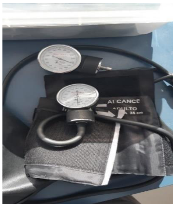
Figura 118troca do manômetro do esfigmomanômetro do setor.
